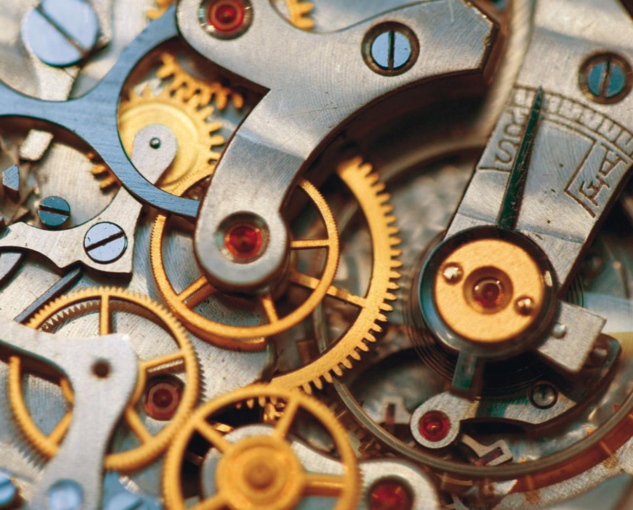
**Mecanismo interior de un reloj.** Las ruedecillas conservan y transmiten el movimiento necesario para el desplazamiento de las agujas.
