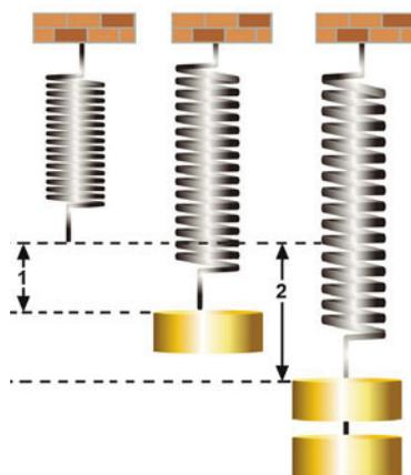
**Ley de Hooke.** El estiramiento de un resorte depende del peso que sostiene.
