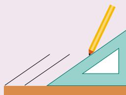
1 Construcción de la recta paralela que pasa por un punto exterior a una recta dada
