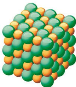
**Estructura microscópica de la sal común.** Los cristales de sal tienen 9 planos de simetría.
