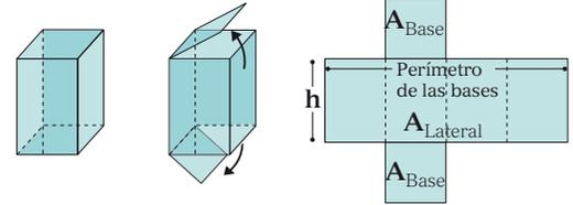
Al desplegar el prisma, su parte lateral es un rectángulo de base igual al perímetro  $P_{Base}$  del polígono de la base (**polígono basal**) y de altura  $h$  igual a la altura el prisma. Así, el área total del prisma es:  $A_{Prisma} = 2 \times A_{Base} + P_{Base} \times h$ .
