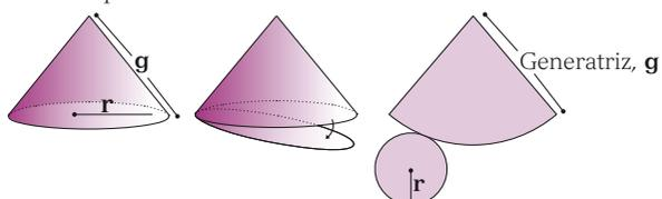
El área total del cono se calcula con:  $A_{\text{Cono}} = \pi \times r^2 + \pi \times r \times g$ .
