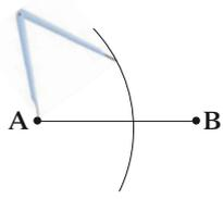
2.º Con la misma abertura del compás, se apoya su punta en el otro extremo del segmento, **B**, y se traza un segundo arco que corte al primero en dos puntos **R** y **S**. La recta  $\vec{I}$  que pasa por los puntos **R** y **S**, es la mediatriz del segmento **AB**.
