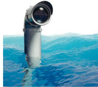
**Periscopio.** Dispositivo óptico usado por los submarinos para observar lo que ocurre en la superficie estando sumergidos.
